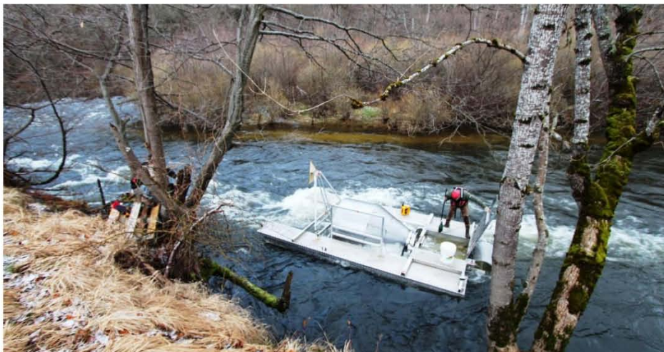
Figure 3 : Illustration des tambours filtrant mis en œuvre pour des échantillonnages de smolts sur l'Allier.
