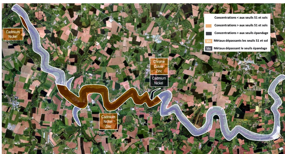
Illustration 9: vue satellitaire du site des retenues où les concentrations de métaux dans les sols sont figurés selon le niveau de dépassement de la norme d'épandage ou du niveau seuil S1 dans les sols.
